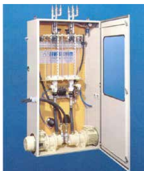
1.4.2. ábra: Üzemi betonadalékszer adagoló berendezés (Forrás: Würschum GmbH)
