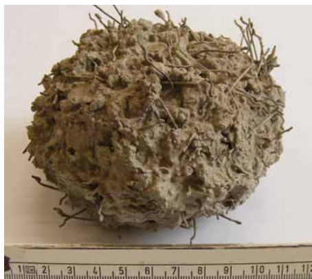
4.6.14. ábra: Kampós végű acélszálak összecsomósodása frissbetonban („sündisznó”)
