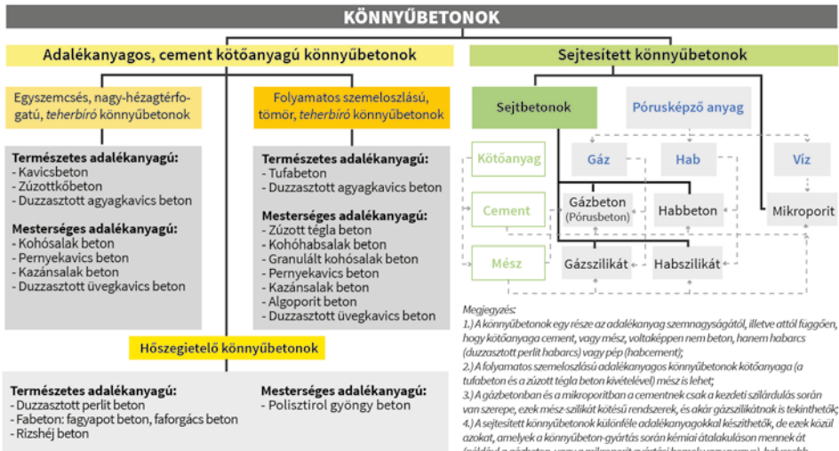
4.6.65. ábra: Könnyűbetonok fajtái [Cement-beton Kisokos, 2008]
