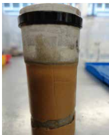
4.6.31/a. ábra: 91 napig ecetsavas oldatba mártott cementkő/korróziós közeg érintkezési felülete [2]
