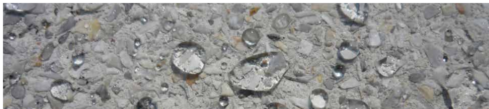
1.4.9. ábra: Vízcseppek hidrofób impregnált felületen
