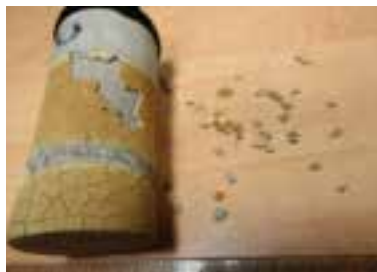
4.6.31/a. ábra: 91 napig ecetsavas oldatba mártott cementkő/korróziós közeg érintkezési felülete [2]
