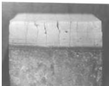
4.6.33/a. ábra: CEM I cementből készített próbatest korróziója salétromsavban 80 nap alatt [3]
