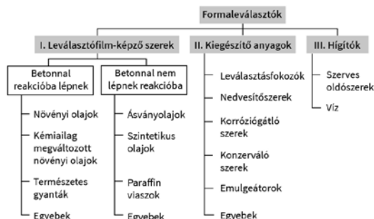
1.4.6. ábra: A formaleválasztók összetétele (Forrás: Sika Beton Kézikönyv)
