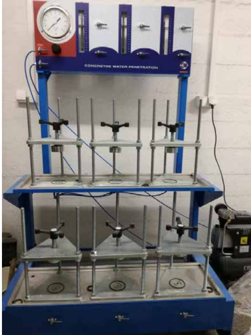
5.9.1. ábra: Vízzáróság vizsgáló berendezés
