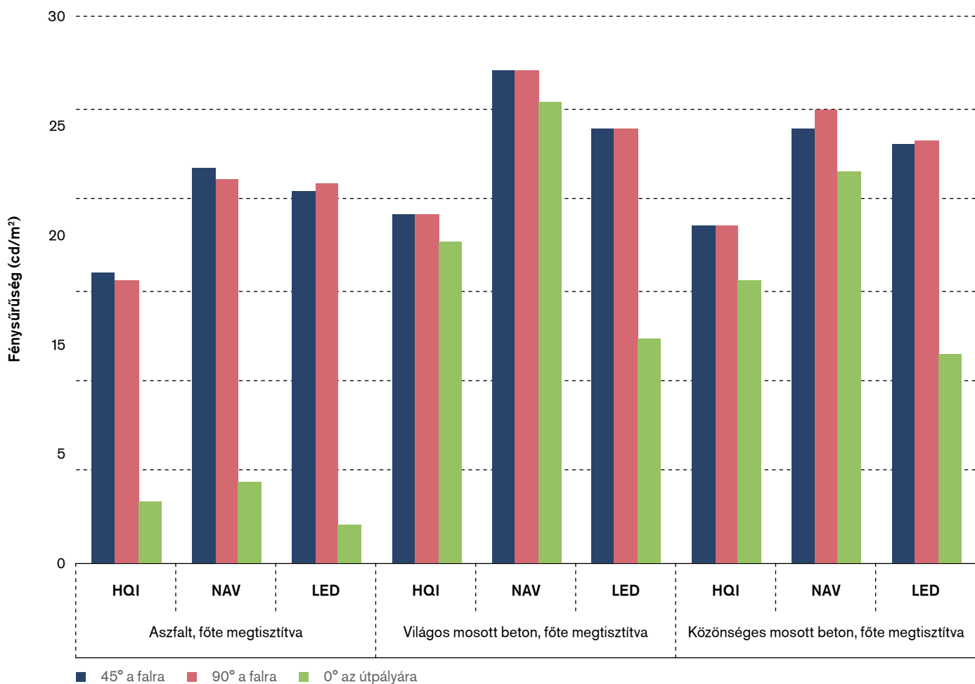
13. ábra: Fénysűrűség az alagútfalon (rátekintési szög 45° és 90°) és a pályafelületen (0°), „átvételi állapotú” alagútfal bevonat esetén a különböző pályakiképzésekre és lámpafajtákra
