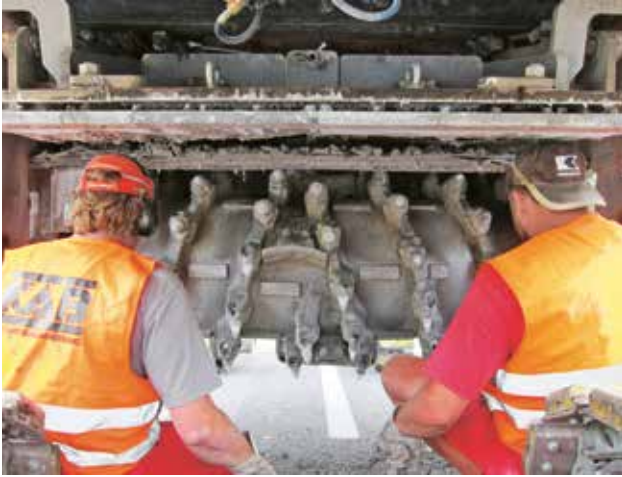
2. ábra: 2,2 m fogási szélességű marófej cseréje
