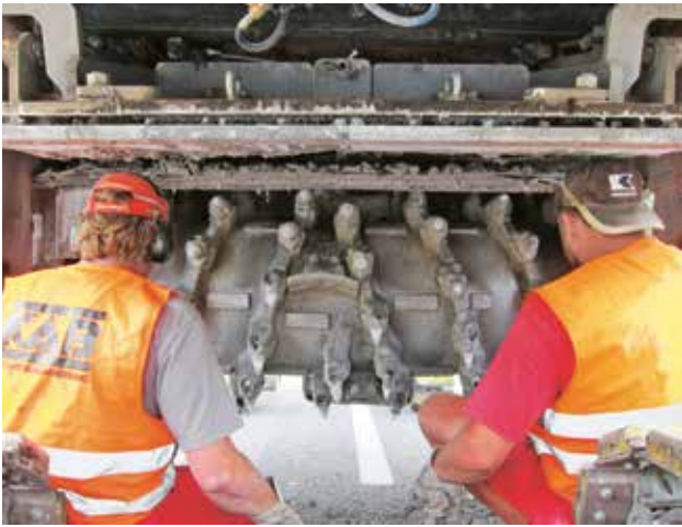
2. ábra: 2,2 m fogási szélességű marófej cseréje
