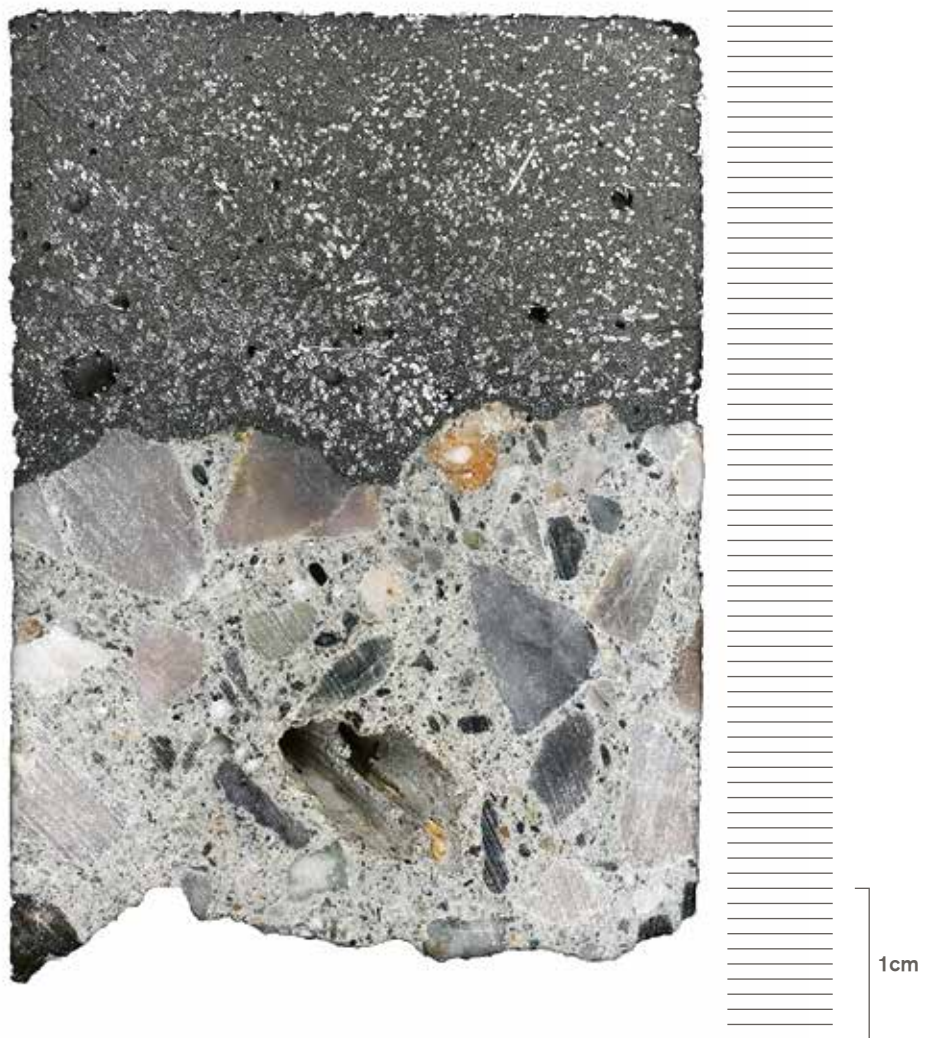
1. kép: A beton és az UNT szálbeton érintkezési szakaszának képe ráeső fényben. A két anyag különbözősége (szemnagyság, szálerősítés, tömörség) szembetűnő
