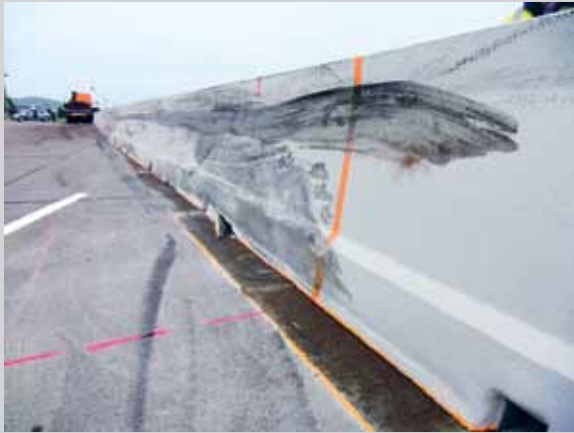
9. kép: Egy igen nagy feltartóztató képességű beton védőfal csak kismértékben tolódik el
