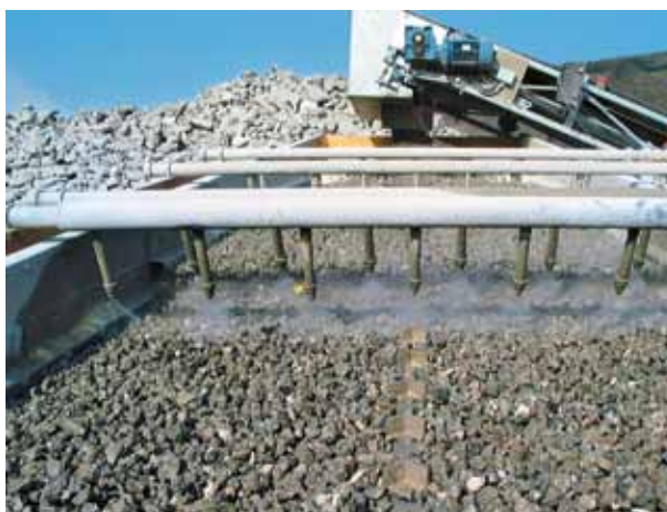
2. ábra: Az újrahasznosítandó szemcsehalmazok rostálása és mosása
